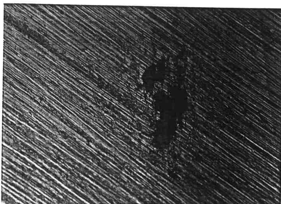
Figura 3.23 - Aspecto de um pite nucleado na liga 3RE60 após ensaio potencioestático a 1100 \text{ mV}_{\text{ECS}} Aumento 100 X.
